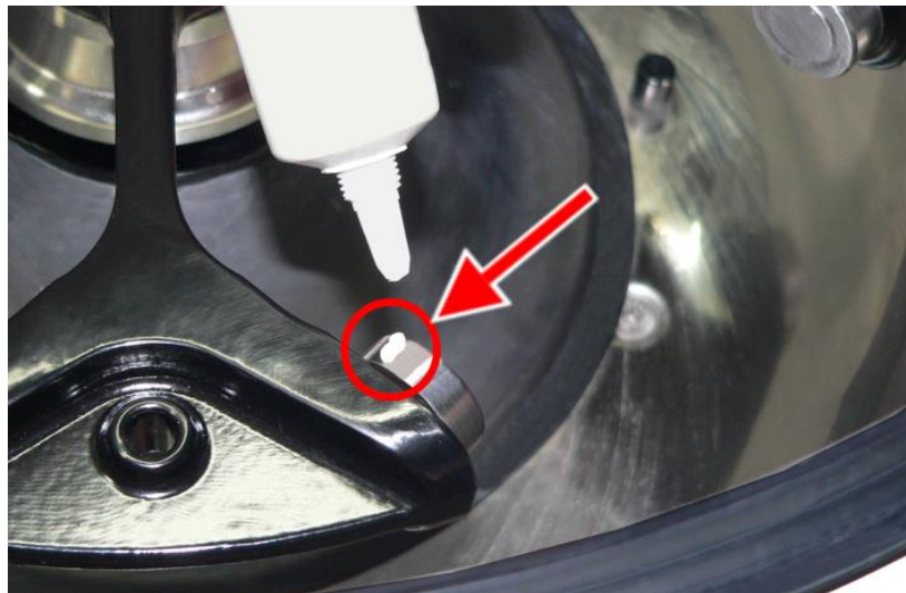
Abb. 36: ausreichende Menge Tragbolzenfett für einen Bolzen
