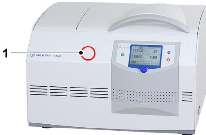
Abb. 34: Position der Öffnung für die Notentriegelung
