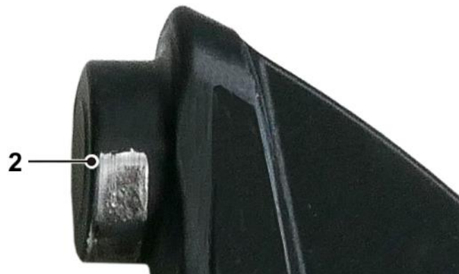
Abb. 8: Tragbolzen mit komplett abgenutzter Gleitbeschichtung – Fetten ist notwendig
