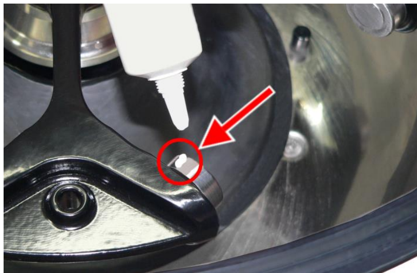
Abb. 34: ausreichende Menge Tragbolzenfett für einen Bolzen
