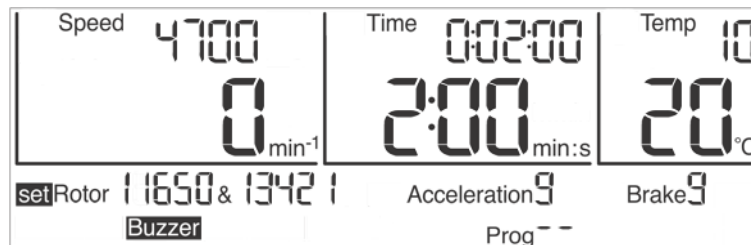
Abb. 23: Auswählen des Rotors bzw. der Rotor-Becher-Kombination
