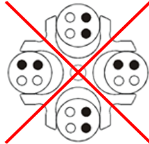
Abb. 12: Zulässige und unzulässige Beladung von Winkel- und Ausschwingrotoren (Beispiele)
