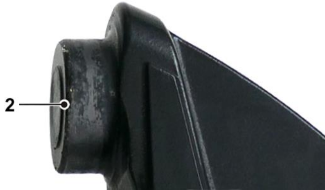
Abb. 7: Tragbolzen mit Gebrauchsspuren – Fetten ist nicht notwendig
