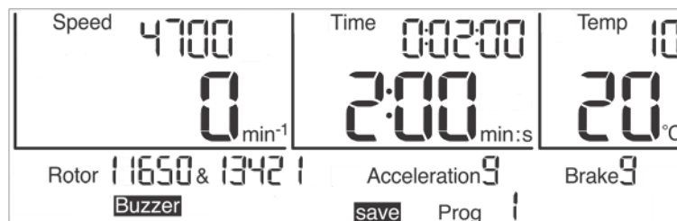
Abb. 31: Speichern eines Programms
