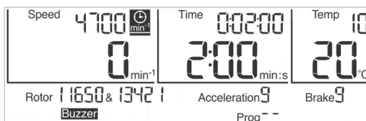
Abb. 18: Die Funktion "Laufzeit ab Solldrehzahl" ist aktiviert
