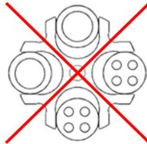
Abb. 11: Zulässige und unzulässige Beladung des Ausschwingrotors mit unterschiedlichen Gefäßgrößen (Beispiel)
