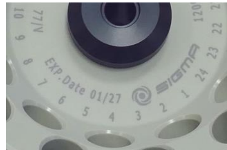
Abb. 5: abweichende Lebensdauer – Gravur auf dem Becher / Rotor
