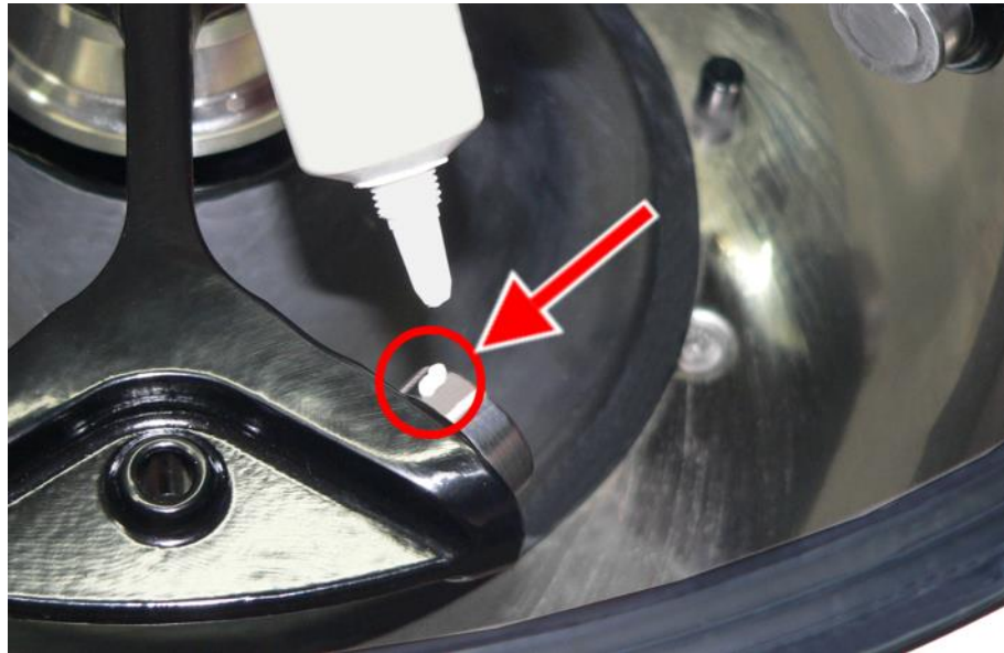
Abb. 16: ausreichende Menge Tragbolzenfett für einen Bolzen
