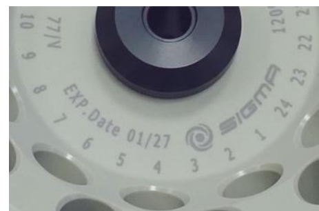
Abb. 5: abweichende Lebensdauer – Gravur auf dem Becher / Rotor
