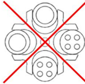
Abb. 9: Zulässige und unzulässige Beladung des Ausschwingrotors mit unterschiedlichen Gläsergrößen (Beispiele)
