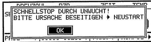
Der Lauf kann nicht mehr fortgesetzt werden (Unwucht > Abschaltsschwelle). Die Zentrifuge wird mit max. Bremsleistung gestoppt.
